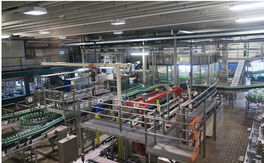
Intérieur de l'usine Valser, mise en bouteilles et transport, Suisse
